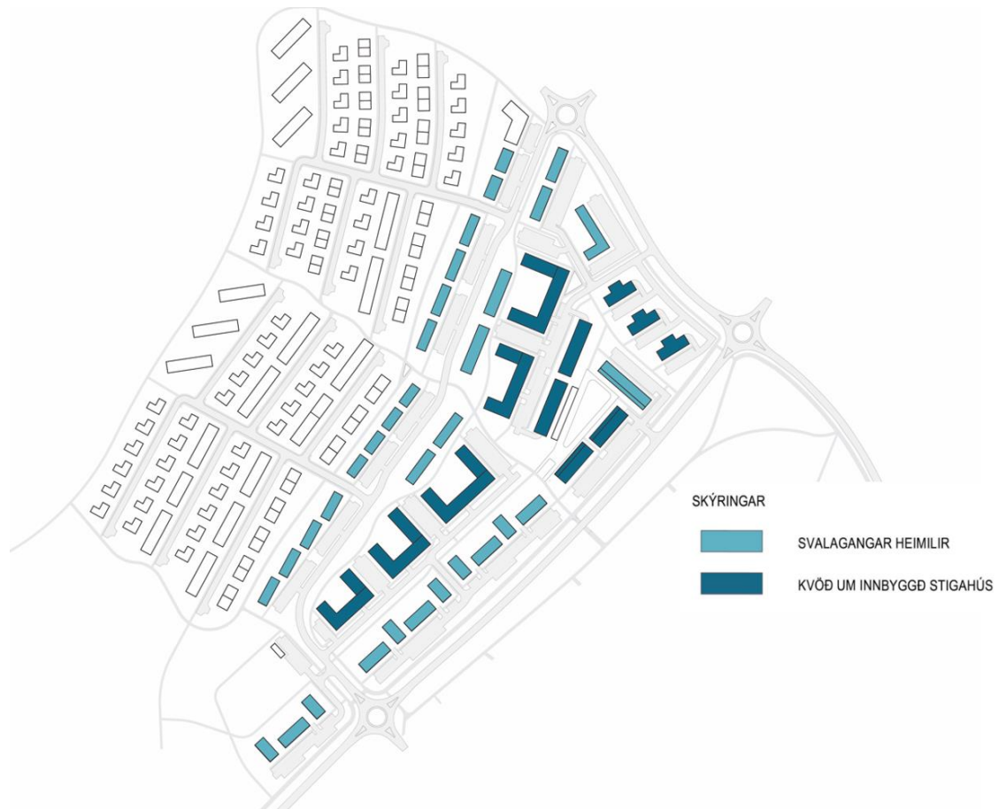
Mynd 7. Stigahús og svalagangar fjölbýlishúsa
